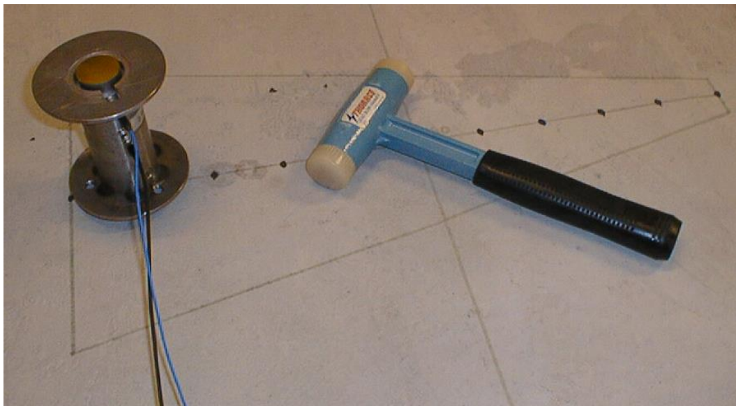
Figur 2. Närbild på det tidigare utvecklade impedanshandtaget t.v. som mäter både kraft i slaget och betongytans hastighet i slagriktningen. Dessa parametrar medger beräkning av betongytans impedans. Hammaren, en sk "Thorace dead blow hammer" är fylld med blykulor. Det gör den rekylfri, dvs inga studsar uppkommer. Det förlänger också impulstiden något.
