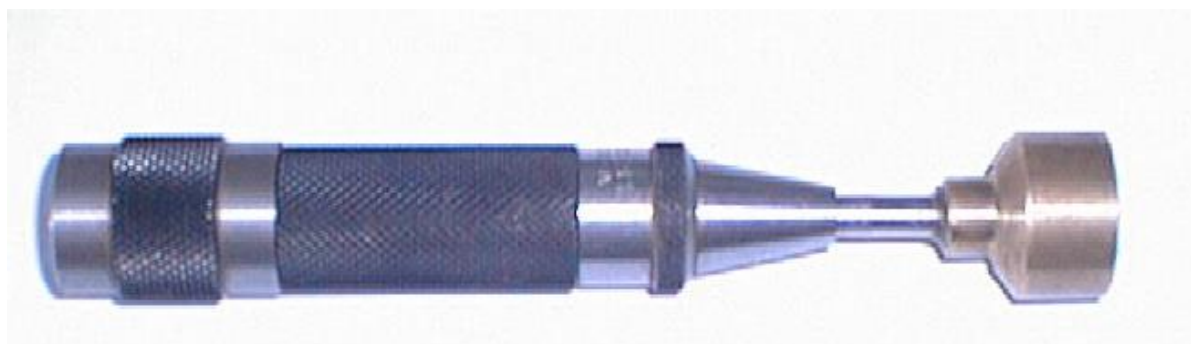
Figur B7. Mikrofon t.v. med förstärkare
