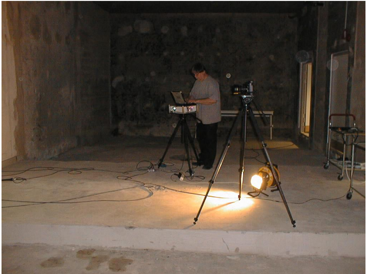
Figur B5. De två stativen med kameran respektive projektorn. På projektorn står datorn som styr allt.
