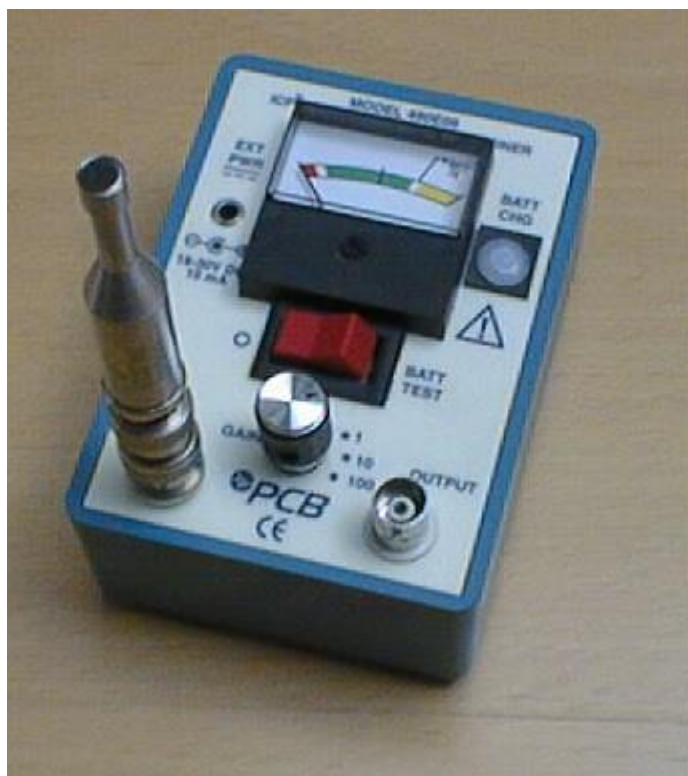
Figur B7. Mikrofon t.v. med förstärkare
